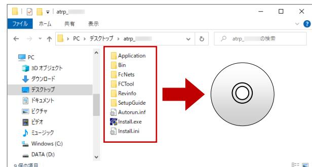
作成したメディアをコンピューターにセットして「Install.exe」を実行すると、セットアップ画面が表示されます（手順3）。
