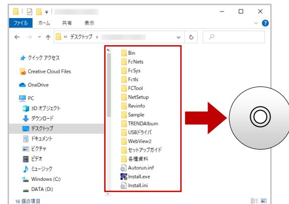
作成したメディアをコンピューターにセットして、「Install.exe」を実行すると、セットアップ画面が表示されます（手順 3）。
